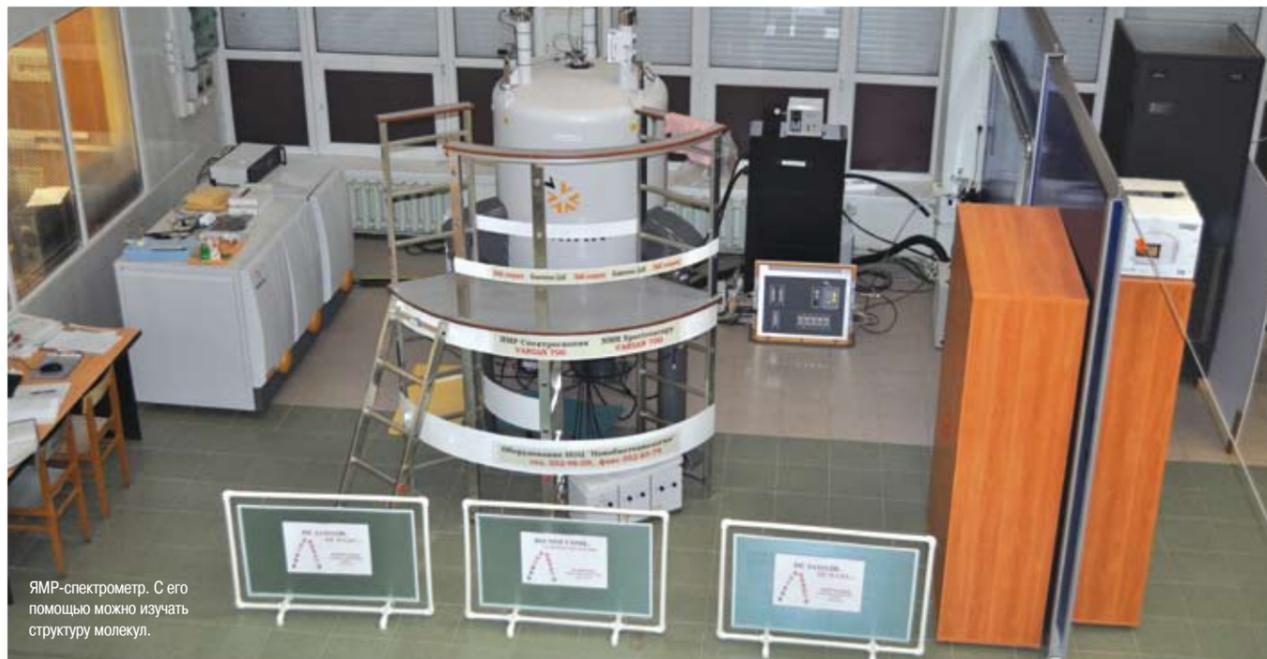
ЯМР-спектрометр. С его помощью можно изучать структуру молекул.
