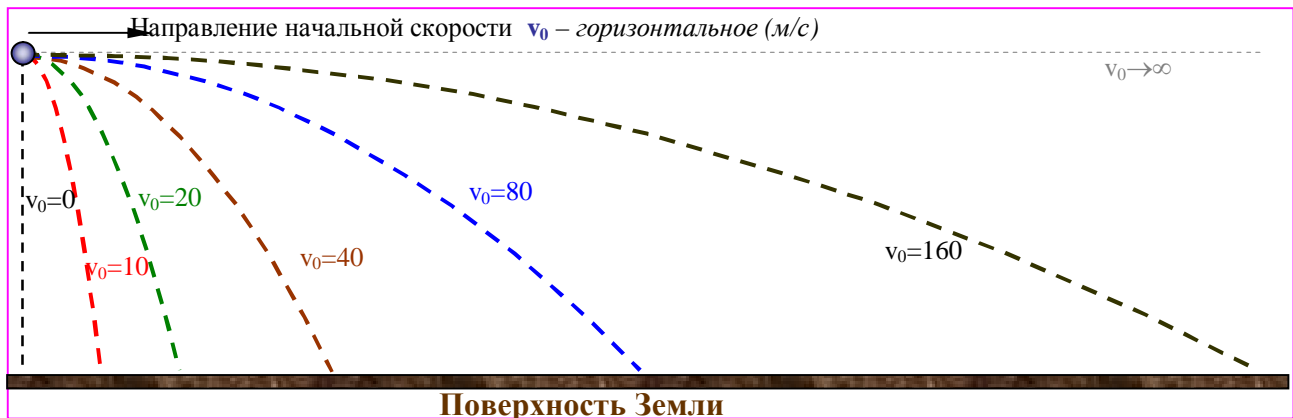
Рис. 2.3п. Все траектории полёта материальной точки вблизи поверхности Земли (когда поверхность можно считать плоской) – это кривые, называемые параболами . Чем больше величина начальной скорости – тем дальше пролетит тело до падения на Землю. При v_0 = 0 тело просто падает вертикально вниз. При очень большой начальной скорости ( v_0 \rightarrow \infty ) траектория полёта тела приближается к горизонтальной прямой.
