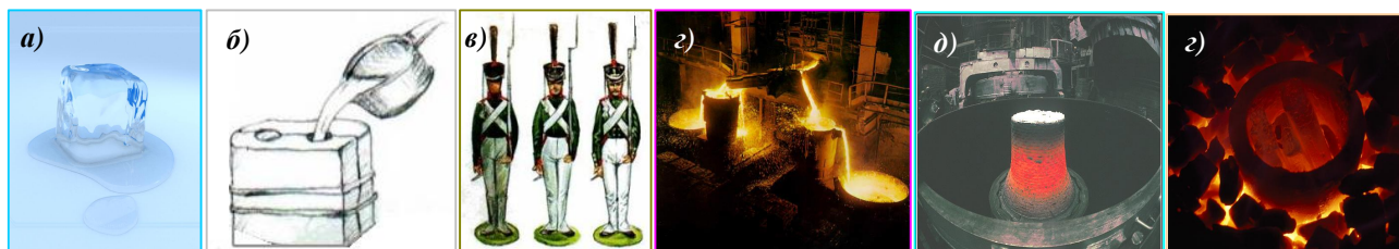
Рис. 9.2. Лёд плавится при внесении его в комнату (а); б) литьё расплавленного олова в форму; в) готовые (отвердевшие, остывшие и раскрашенные) оловянные солдатики; г) разливка расплавленной стали; д) затвердевшая, но не остывшая отливка крупной стальной заготовки; е) плавка золота в тигле.
