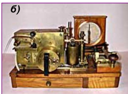
Рис. 183. Электромагниты и их применение. а) один из первых электромагнитов Дж. Генри. б) телеграфный аппарат Морзе, работа которого была бы невозможна без электромагнитов. в) современный промышленный электромагнит. г) подъёмный кран с электромагнитом.
