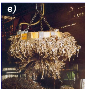
Рис. 183. Электромагниты и их применение. а) один из первых электромагнитов Дж. Генри. б) телеграфный аппарат Морзе, работа которого была бы невозможна без электромагнитов. в) современный промышленный электромагнит. г) подъёмный кран с электромагнитом.
