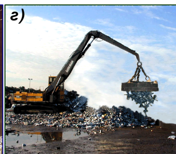
Рис. 183. Электромагниты и их применение. а) один из первых электромагнитов Дж. Генри. б) телеграфный аппарат Морзе, работа которого была бы невозможна без электромагнитов. в) современный промышленный электромагнит. г) подъёмный кран с электромагнитом.
