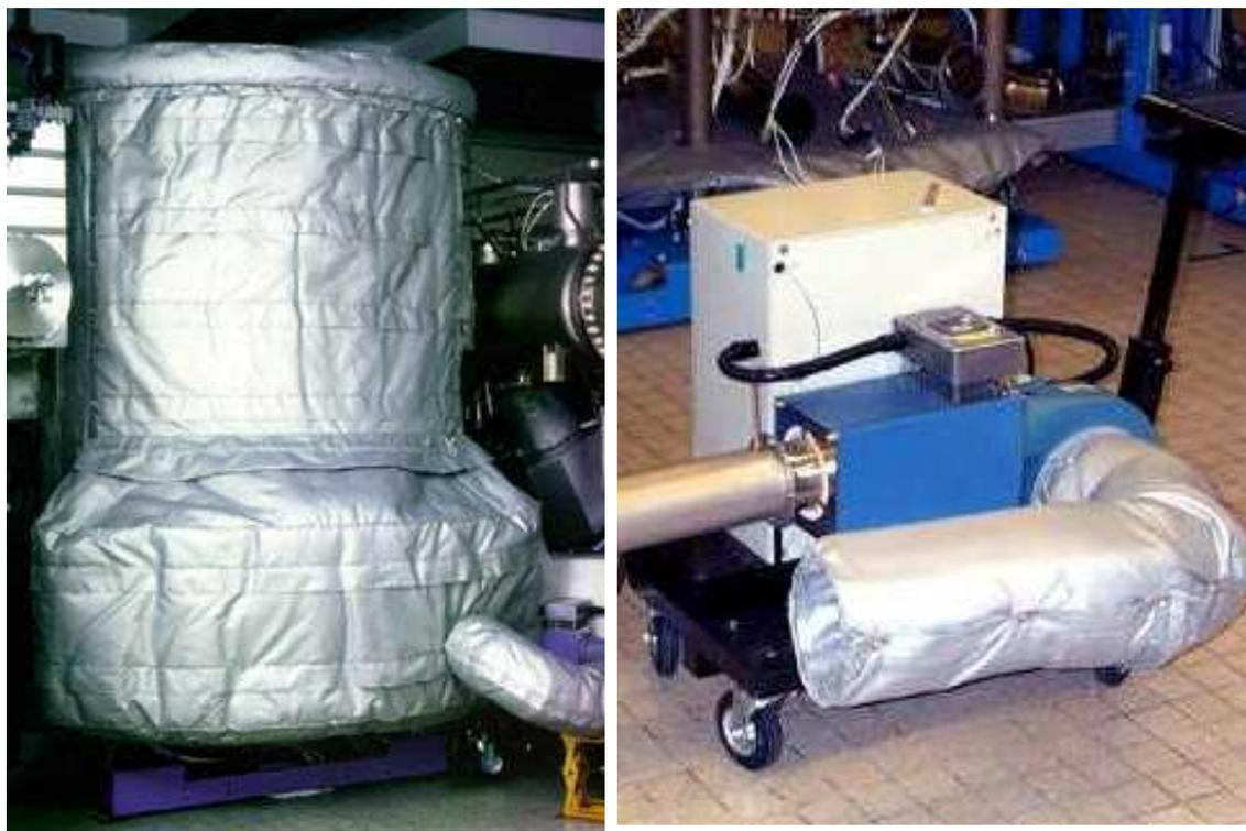
Рис.7. Термоизолирующий кожух (слева) и тепловая пушка (справа) – элементы системы высокотемпературного отжига установки МПЭ RIBER 49.
