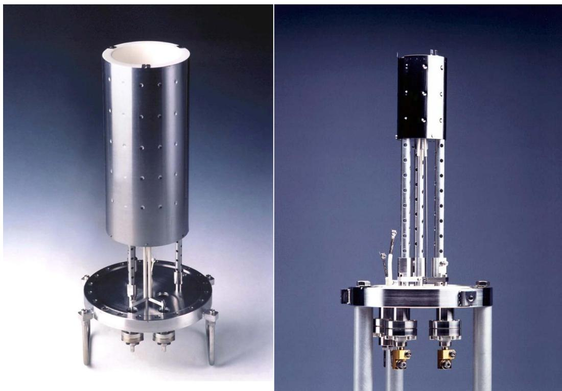
Рис.6. Эффузионные источники установки молекулярно-пучковой эпитаксии RIBER49. Источник для испарения Al, Ga и In, модель ABN700 с двухзонным нагревательным элементом (слева), источник для испарения легирующих примесей Si и Be, модель ABN160 (справа).
