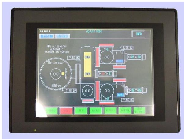
Рис. 9. Сенсорный экран установки молекулярно-пучковой эпитаксии RIBER49.
