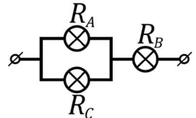
В схеме (см. рис.) лампы  $A$  и  $C$  параллельны, поэтому их напряжения одинаковы, и из  $R_A < R_C$  следует  $P_A > P_C$ .
